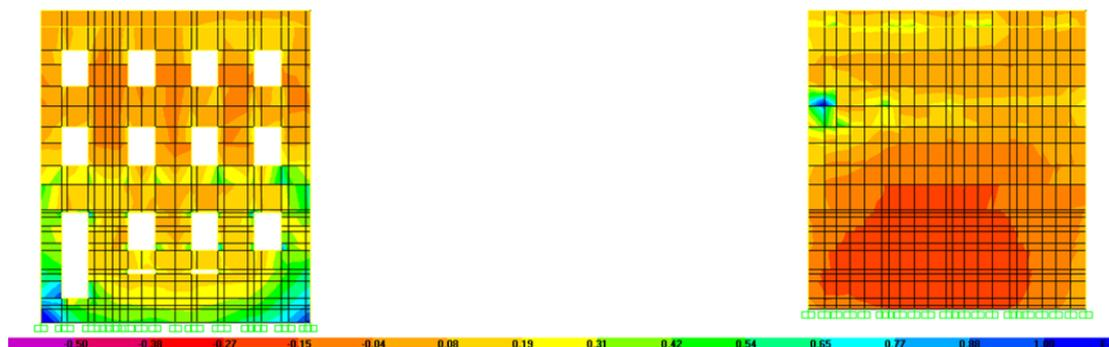
**Figura 7.5 – Diagrama de tensões verticais para as alvenarias de fachada secundária (plano K) devido à Combinação Sísmica (tração máxima – kPa), no modelo com recurso a cantoneiras 2L100x100x10**
