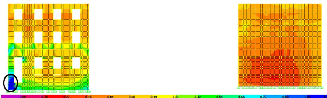
Figura D. 3 – Diagrama de tensões verticais para as alvenarias de fachada secundária (plano K) devido à Combinação Sísmica (tração máxima – kPa) no modelo com diafragmas rígidos
