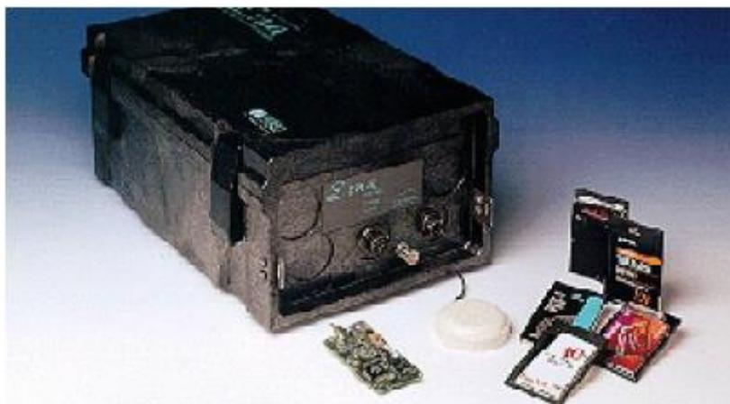
Figura 4.8 - Equipamento utilizado para registo de acelerações [Kinematics, 1995].
