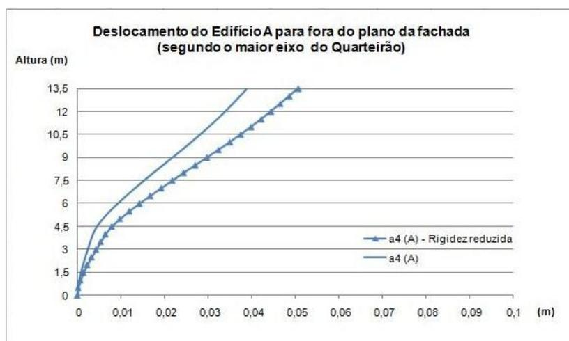
Gráfico 15 - Amplitude dos deslocamentos dos alinhamentos verticais a4 para fora do plano da fachada (segundo o maior eixo do Quarteirão), considerando o Quarteirão-Tipo Base e o Quarteirão-Tipo de rigidez reduzida.
