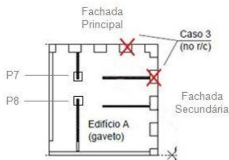
Figura 94 – Identificação das alterações estruturais implementadas no Edifício de Gaveto no Caso 3.
