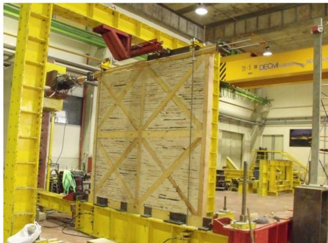
Figura 16 - Fotografia do espécime parede de frontal pronto a ensaiar (Meireles, 2010).
