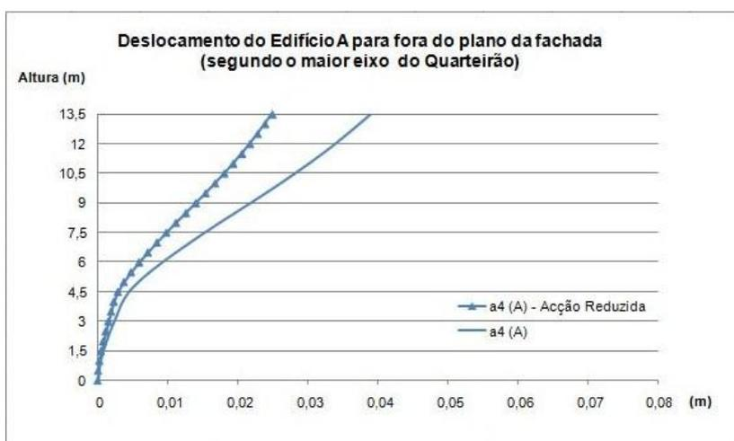
Gráfico 11 - Amplitude dos deslocamentos do alinhamento vertical a4, considerando o Quarteirão-Tipo Base e o Quarteirão-Tipo solicitado por ação sísmica reduzida.
