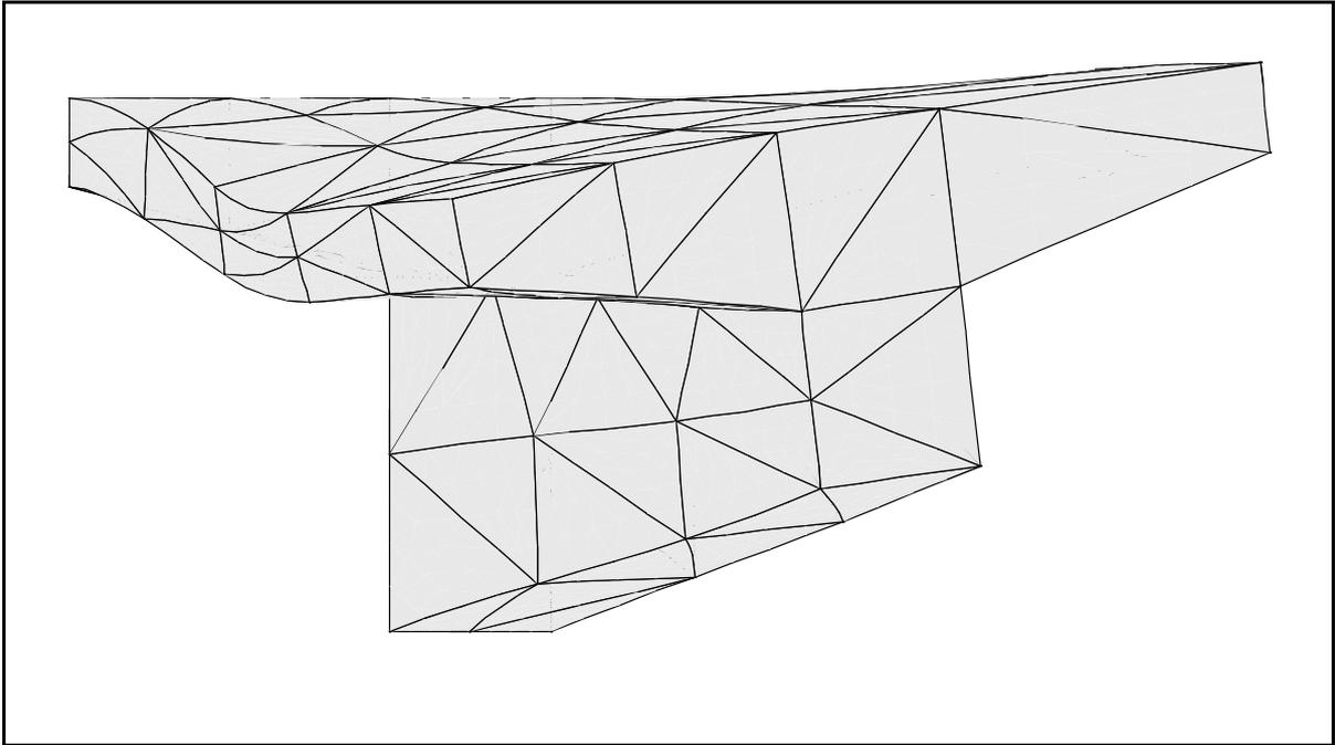
Figura 13.5 - Deformada obtida com elementos compatíveis de grau três.
