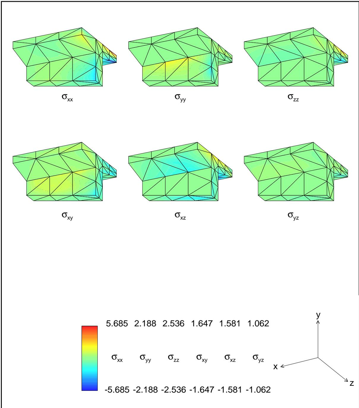
Figura 13.4 - Tensões obtidas com elementos de equilíbrio de grau três.
