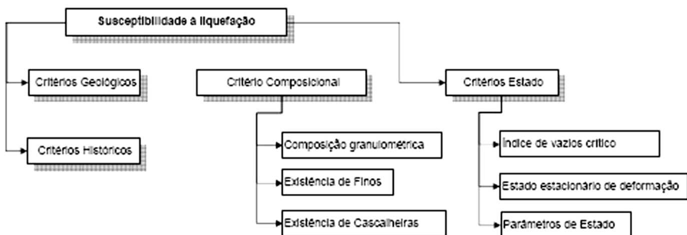
Figura 1. Critérios geralmente utilizados para a avaliação da susceptibilidade à liquefacção
