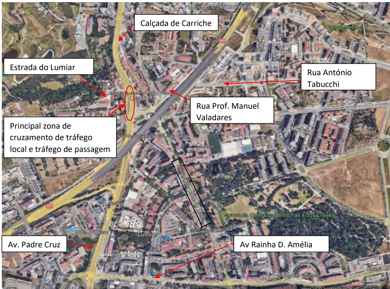
Figura 3 – Identificação de zonas de tráfego local engarrafado devido ao efeito de barreira
