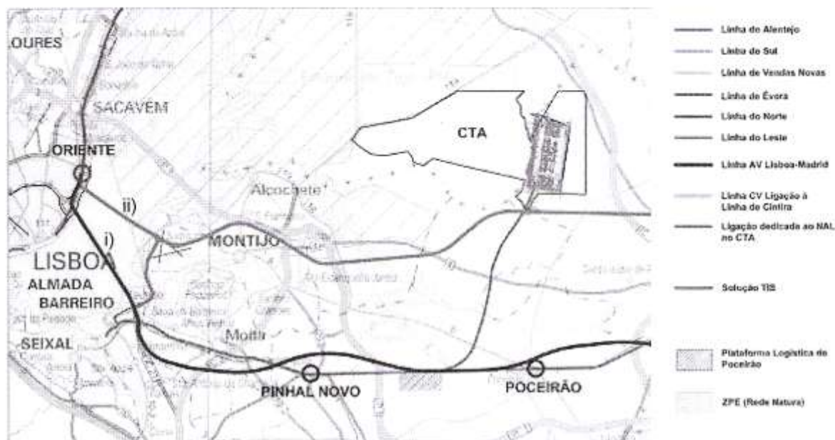
Figura 18– Ligações ferroviárias ao NAL, de acordo com as alternativas de localização da Terceira Travessia do Tejo em Lisboa (fonte: RAVE)
