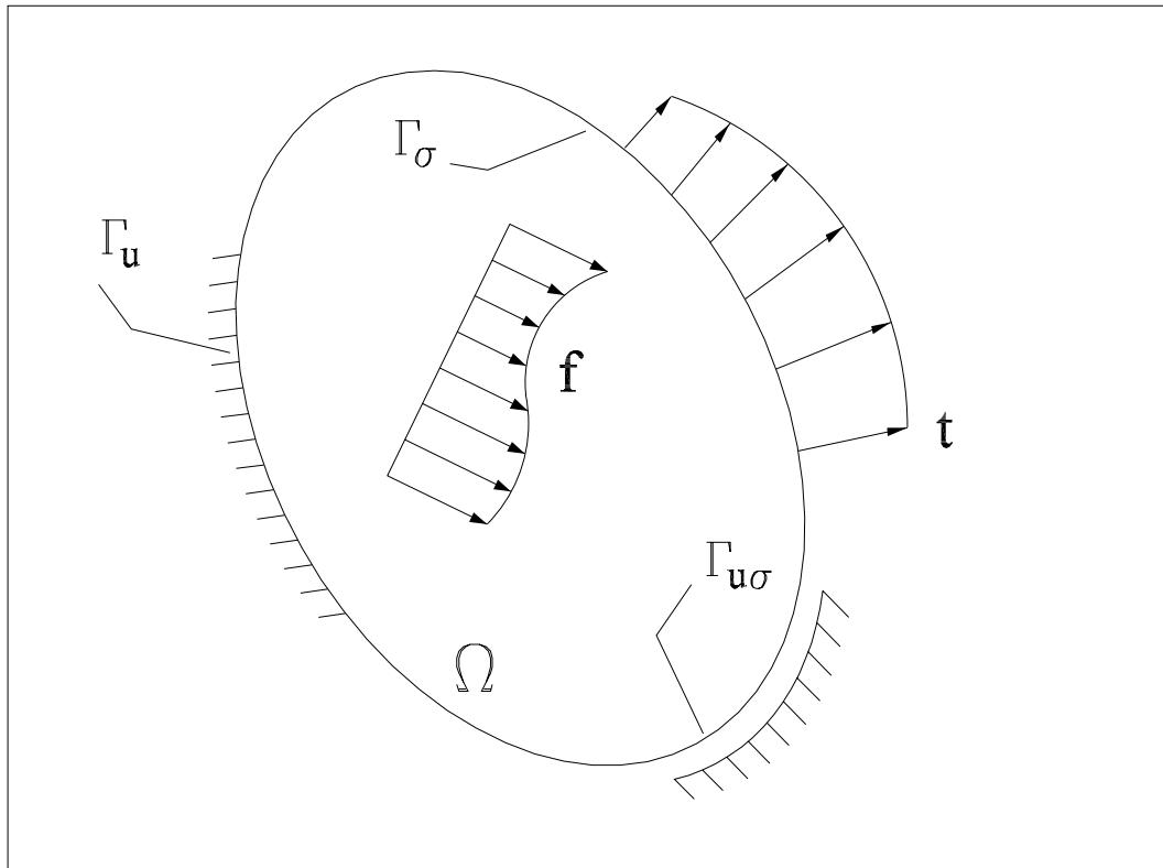
$$\mathbf{f} = \begin{Bmatrix} f_x \\ f_y \end{Bmatrix} \quad \mathbf{t} = \begin{Bmatrix} t_{x\gamma} \\ t_{y\gamma} \end{Bmatrix}$$
