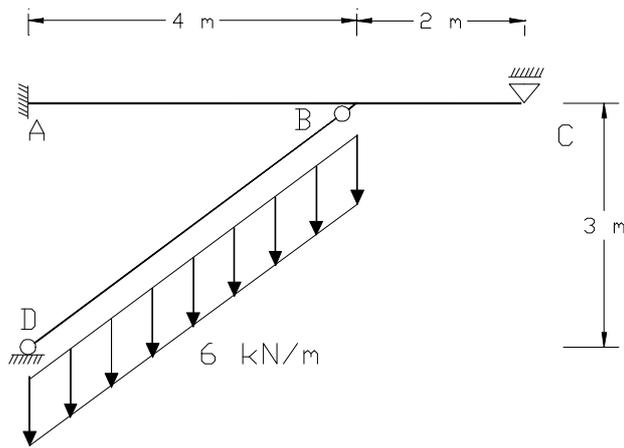
A viga ABC da estrutura representada na figura 5 tem rigidez à flexão constante,  $2EI$  ( $\text{kNm}^2$ ) e é axialmente rígida,  $(EA)_{ABC} = \infty$ . A barra BD tem rigidez à flexão  $EI$  e é axialmente deformável,  $(EA)_{BD} = 10EI$  ( $\text{kN}$ ).
