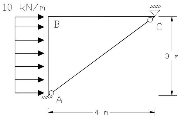
As barras da estrutura têm a mesma rigidez à flexão,  $EI$  ( $\text{kNm}^2$ ), e à deformação axial,  $EA = 6EI$  (kN).
