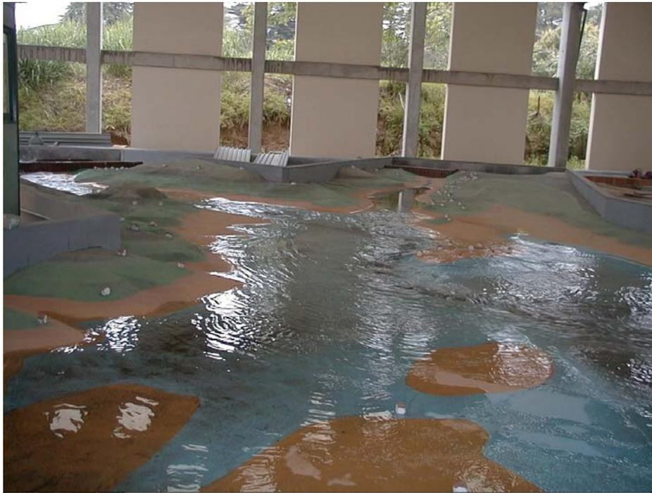
Figura 7.19 - Modelo físico do rio Arade construído no LNEC (Projecto NATO).
