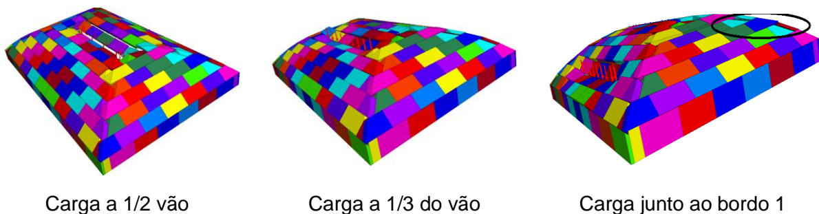
Figura 13. Mecanismo de colapso da abobadilha de engras .
