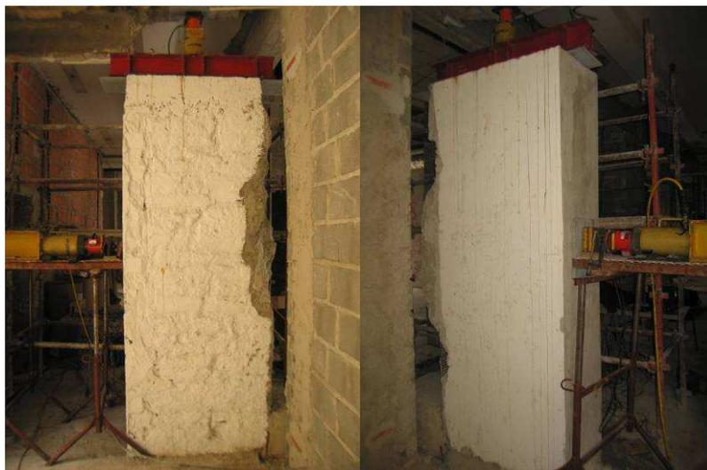
Figura 5: Modelos de parede de alvenaria de blocos de pedra não reforçada (esq.) e reforçada (dta.).
