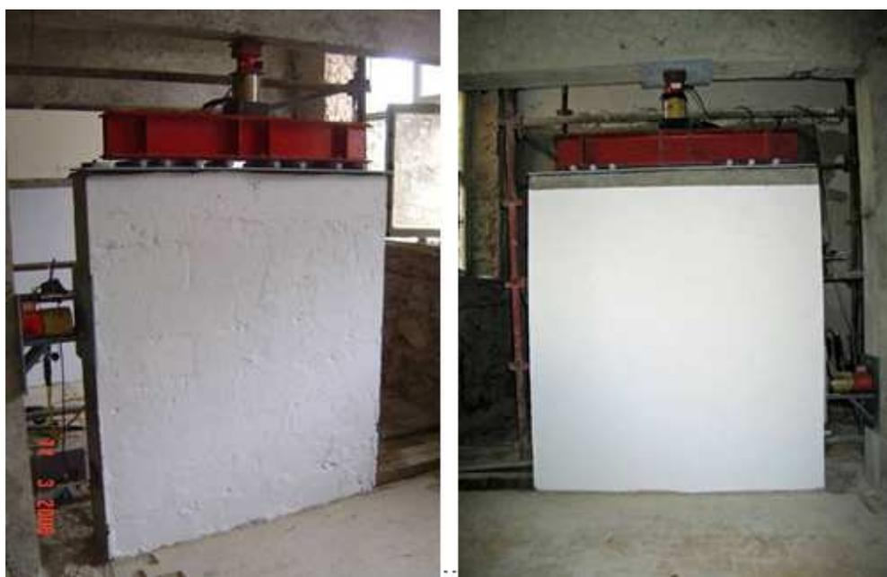
Figura 4: Modelos de parede de alvenaria de blocos de betão não reforçada (esq.) e reforçada (dta.).
