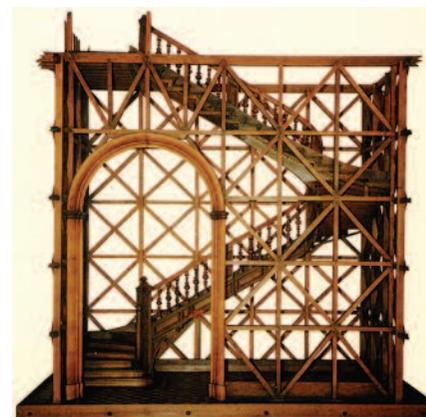
Fig. 1 – Maquete de estrutura de edifício pombalino (Museu de Engenharia Civil do Instituto Superior Técnico)
