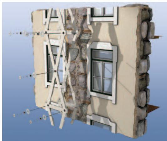
Fig. 11 – Solução de reforço da STAP. Disposição das faixas e pormenor dos conectores de confinamento (STAP)
