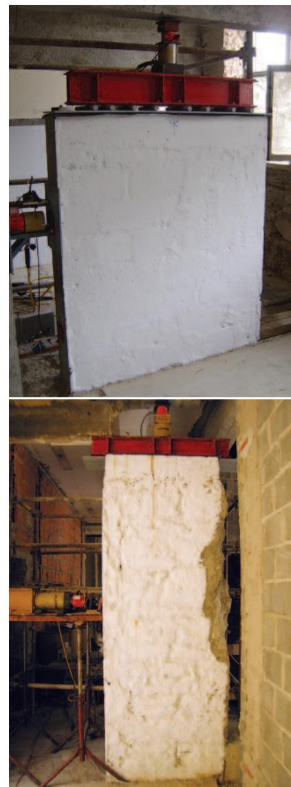
Fig. 9 – Vista geral de dois modelos experimentais de paredes em alvenaria de blocos de betão e em alvenaria de pedra
