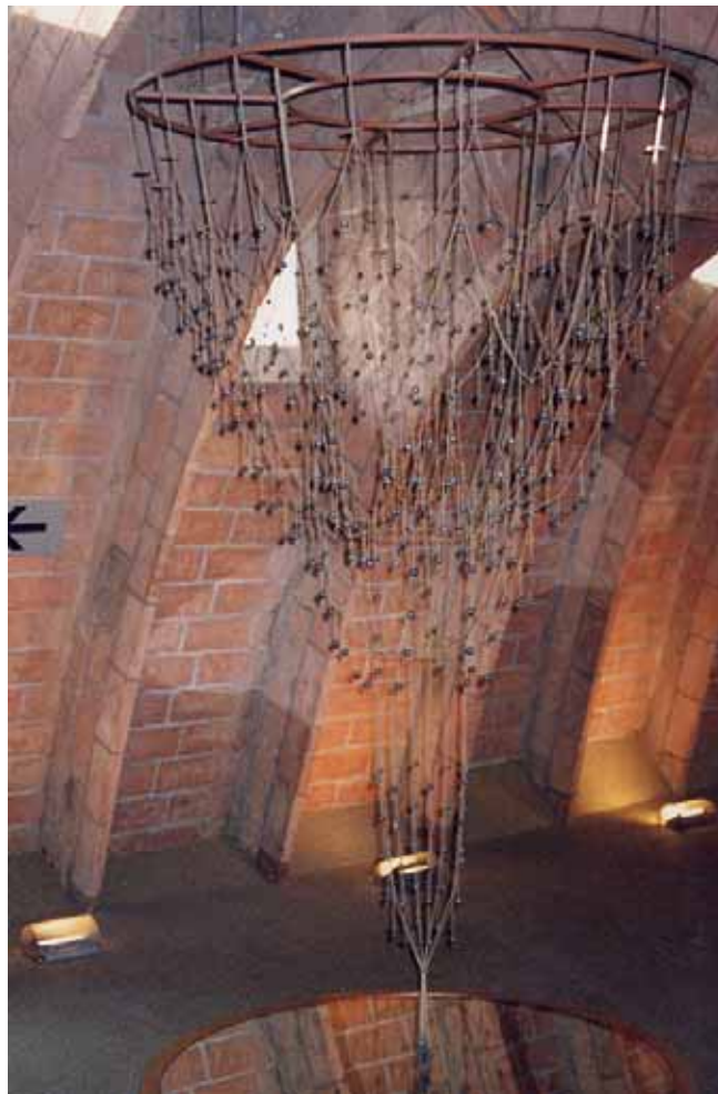
Figura 2.33 - Modelo de Gaudí para o dimensionamento de cúpulas através da analogia entre arcos e correntes suspensas.
