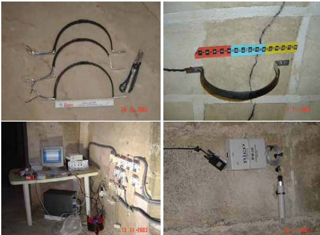
Figura 6.28 - Instrumentação: sensores de deslocamento - precisão 0.1 mm (em cima); sensor para registo de temperatura ambiente e humidade relativa - precisão 0.01 °C e 0.01 % (em baixo à direita); sistema de aquisição de dados (em baixo à esquerda).
